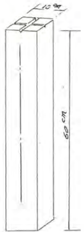
境界標石断面図 \gamma = 1:100
