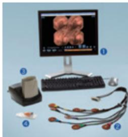
①ワークステーション②センサアレイ③データレコーダ(データ記録装置)④カプセル内視鏡
