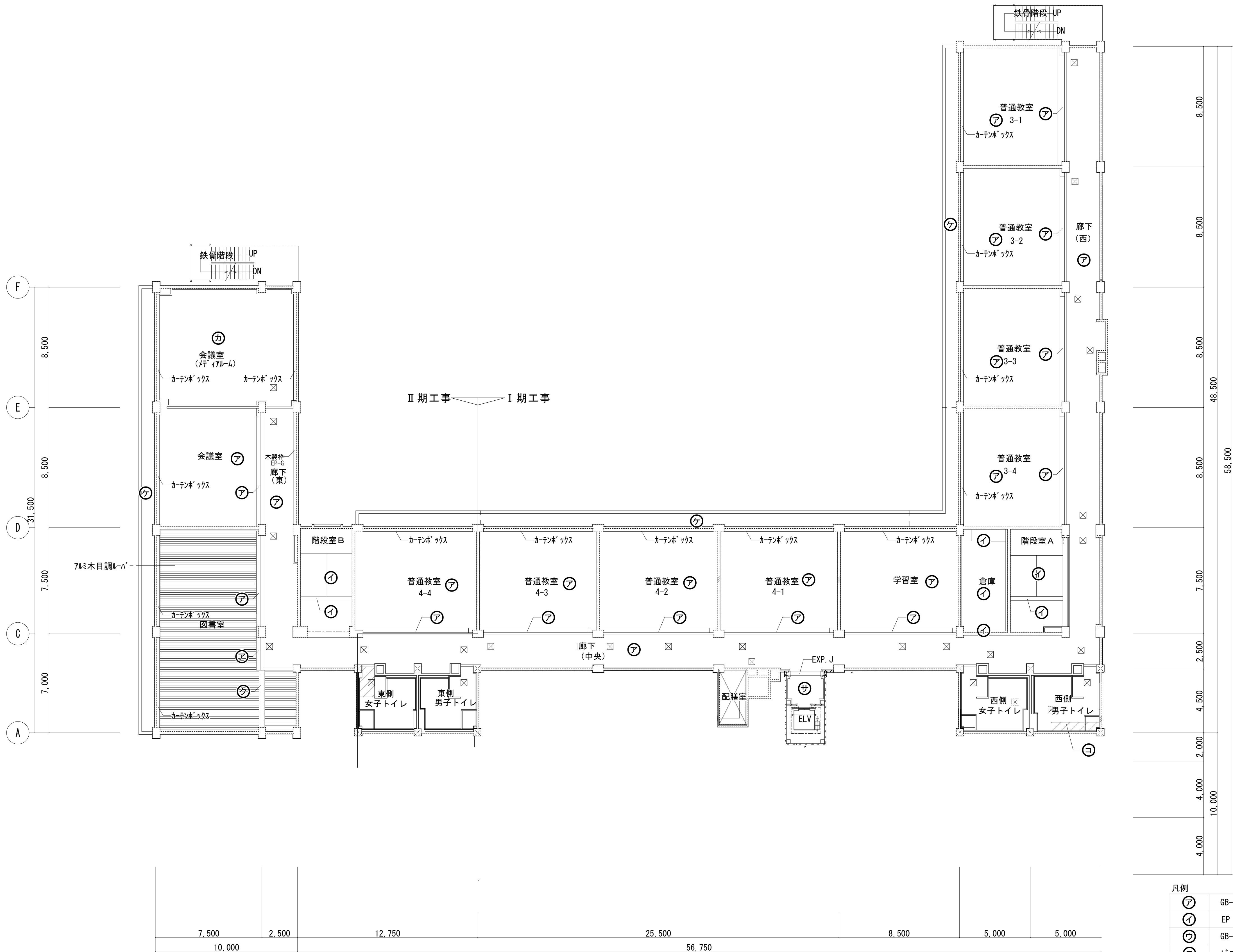
校舎3階天井伏図（改修） 1/150
