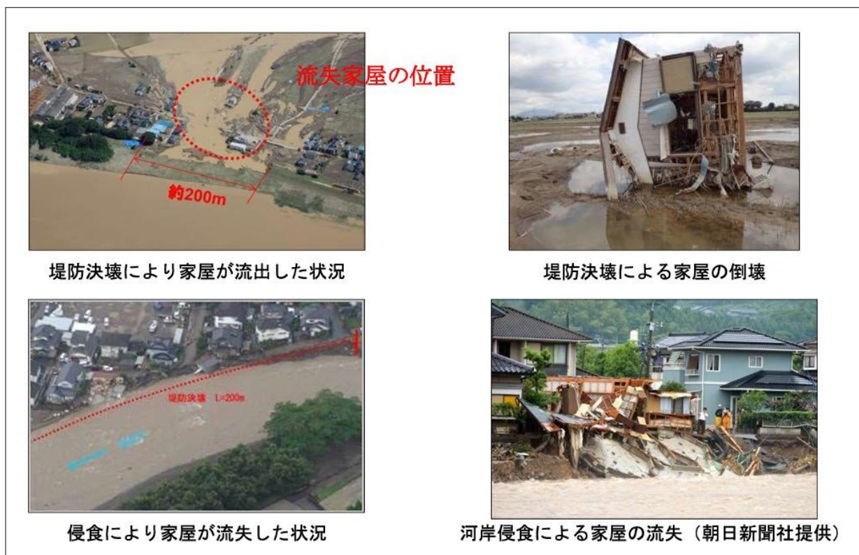
図 堤防決壊や河岸浸食による被害の例
