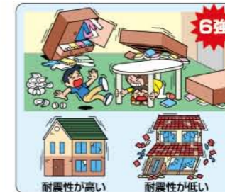
● はわないと動くことができない。飛ばされることもある。 ● 固定していない家具のほとんどが移動し、倒れるものが多くなる。 ● 耐震性の低い木造建物は、傾くものや、倒れるものが多くなる。 ● 大きな地割れが生じたり、大規模な地すべりや山体の崩壊が発生することがある。
