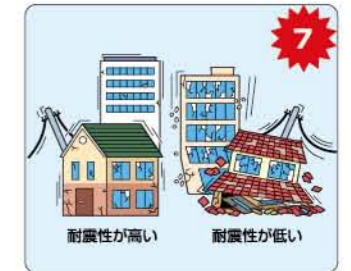
● 耐震性の低い木造建物は、傾くものや、倒れるものがさらに多くなる。 ● 耐震性の高い木造建物でも、まれに傾くことがある。 ● 耐震性の低い鉄筋コンクリート造の建物では、倒れるものが多くなる。
